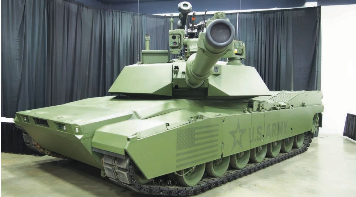
يركز مشروع الدبابة المستقبلية M1E3 Abrams الذي تقوده شركة General Dynamics Land Systems (GDLS) على إعادة هندسة الدبابة لخفض وزنها إلى ما دون 60 طناً
