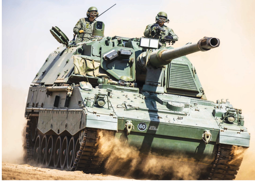
نظام المدفعية الذاتي الحركة المجنزرة الألماني PzH 2000 عيار 155 ملم/ كالبير 52 من صنع KMW
