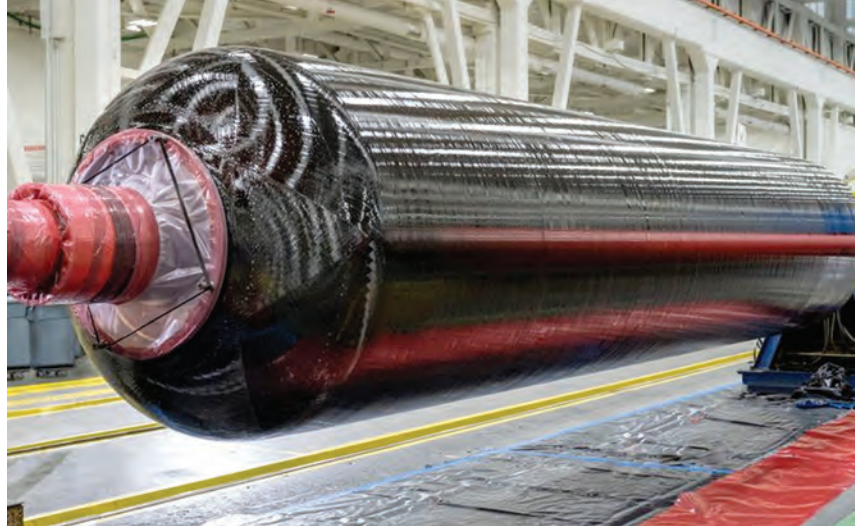
نجحت شركة Northrop Grumman في تصنيع المجموعة الأولى من علب المحركات الصاروخية الصلبة (أحد الأجزاء الموضحة في الصورة هنا) لبرنامج NGI التابع لوكالة الدفاع الصاروخي (MDA). الصورة: Northrop Grumman
