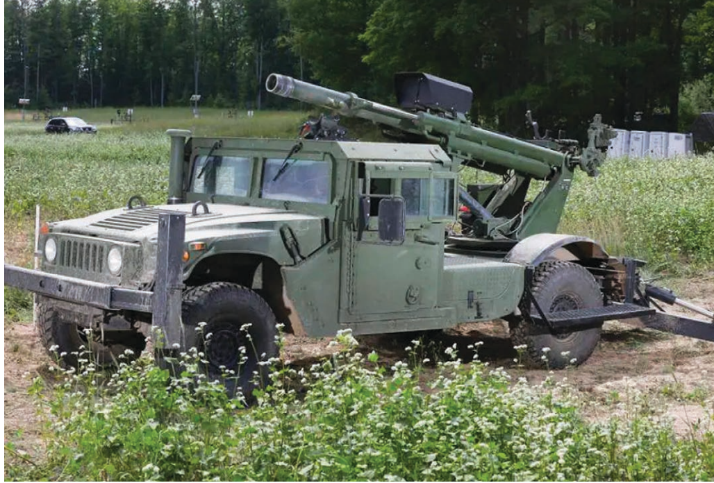
وأحدث مشروع لتطوير مدافع الهاوتزر هو «نظام الهاوتزر النقال» (MHS) Mobile Howitzer System (MHS) عيار 105 ملم Humvee 2-CTHAWKEYE، المصمم من قبل MANDUS GROUP وشركة AM General.
