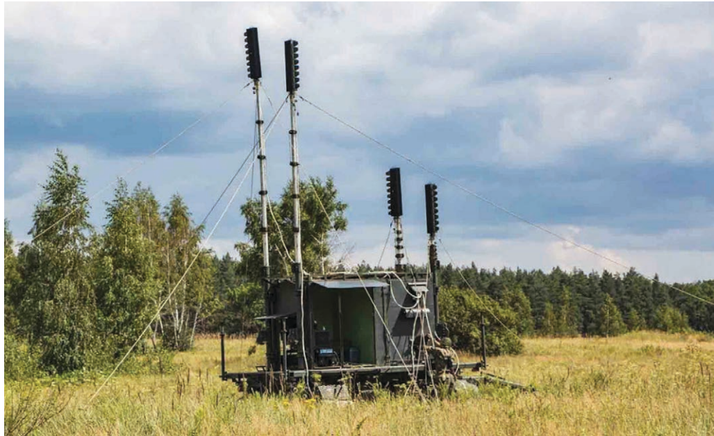
يُحدث نظام R-330Zh Zhitel اضطراباً في الاتصالات الساتلية بـ «الترددات فوق العالية» (UHF) والملاحة ضمن نطاق 30 كيلومتراً
