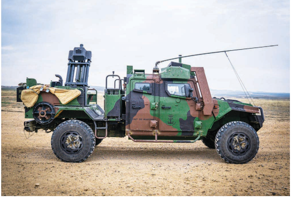
صنعت الشركة الإسبانية «إكسبال» EXPAL نظام Dual-Eimos، الذي يتألف من مدفعي هاون عيار 81 ملم على متن منصة VAMTAC ST5 رباعية الدفع من صنع شركة Eurovesa
