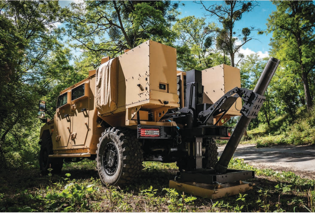
توفر شركة Arqus الفرنسية حالياً نظام A2M SHERPA، الذي يدمج معاً هاون 120 ملم مع منصة الرمي NTGS
