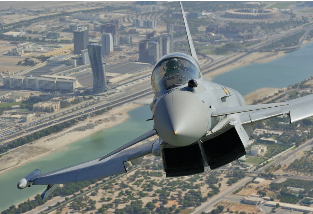
«عدة التعقب الخامد بالأشعة تحت الحمراء المحمولة جواً» PIRATE المحمولة على مقاتلات Eurofighter Typhoon والتي تعتمد على تكنولوجيا الأشعة تحت الحمراء العاملة بالموجة الطويلة
