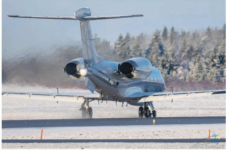
تشغل القوات الجوية السويدية طائرة نفاثة تجارية معدلة من طراز Gulfstream IVSP للقيام بمهام الاستخبار الإلكتروني ELINT، وتعرف بتسمية S102B Korpen. الصورة: Gulfstream.
