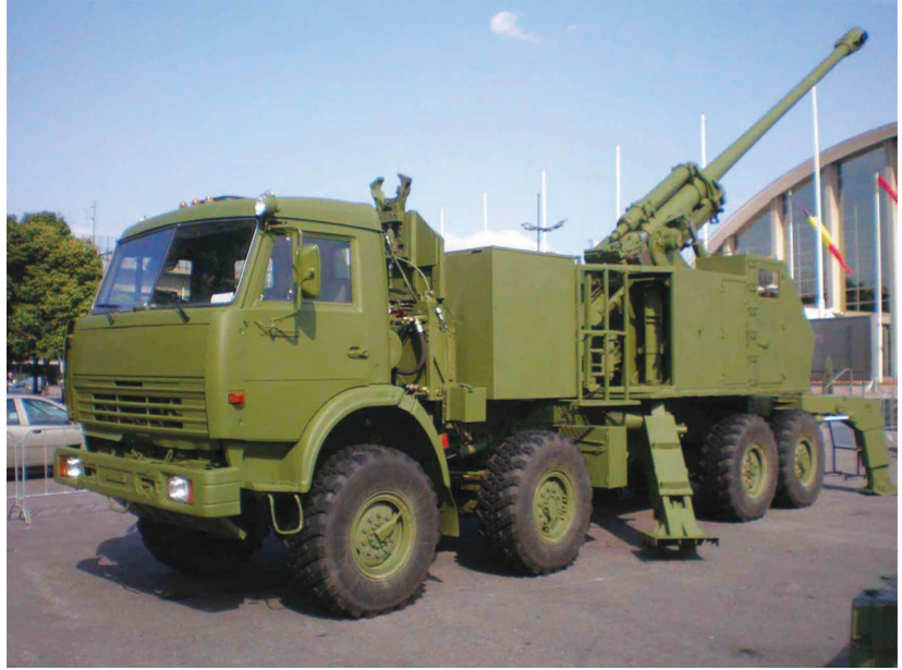
طورت شركة Yugoimport النظام المدفعي الذاتي الحركة المدولب NORA B52 عيار 155 ملم / كاليلير 52، وهو مجهز ببرج مدرع يقع في مؤخرة العربة
