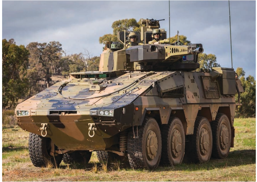
جهزت عربة قتال المشاة Boxer الثمانية الدفع ببرج Rheinmetall LANCE مسلحة بالمدفع MK30-2 عيار 30 ملم ومركن سلاح مشغل من بُعد مركباً على سطح العربة ومسلحاً برشاش ثقيل عيار 12.7 مع خيار لصواريخ ATGM
