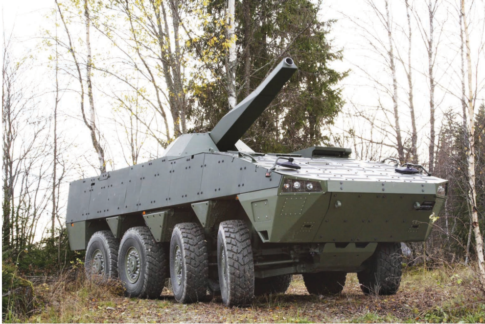
العميل الأول لبرج الهاون Patria NEMO عيار 120 ملم كانت المملكة العربية السعودية، ويبدو في الصورة مركباً على عربة AMV 8x8
