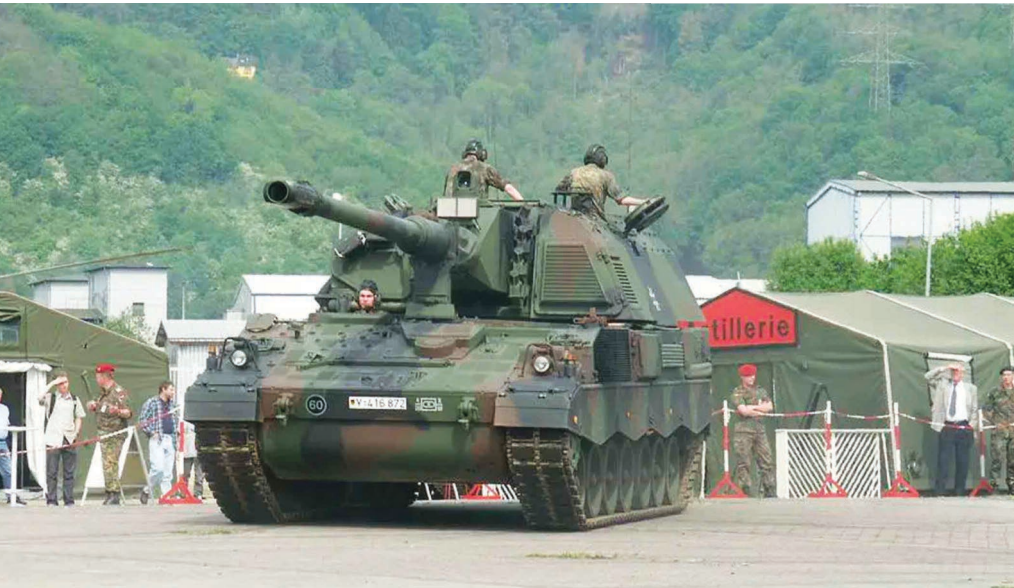
يستخدم الجيش الألماني المدفع PzH 2000 عيار 155 ملم / كالبر 52 وهو من صنع شركة KMW الوحيد في الترسانة الألمانية
