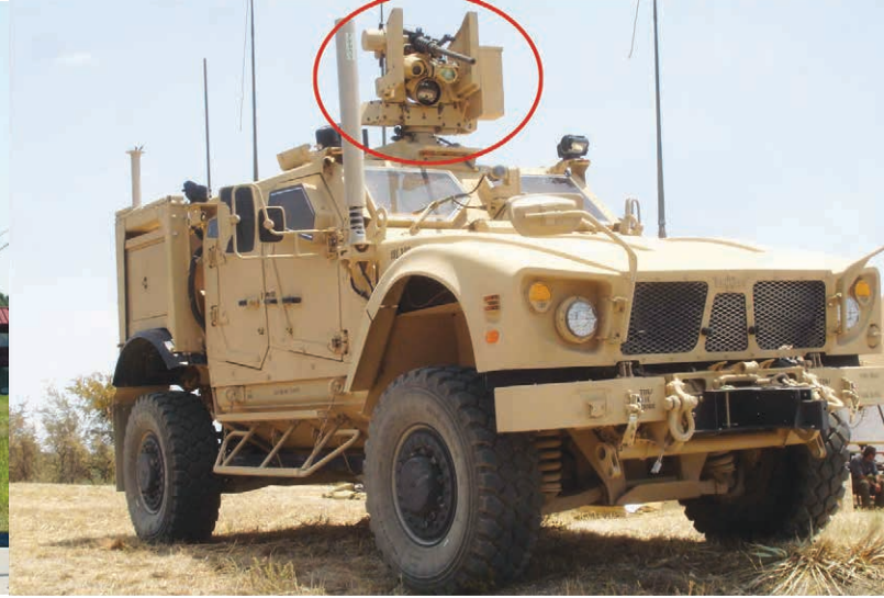
مركز السلاح المشترك المشغل عن بُعد M153 CROWS صنع Oshkosh مركباً على عربة M-ATV صنع Oshkosh
