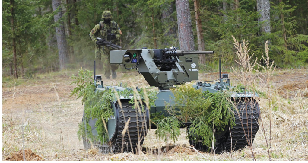
عمّلت شركة FN Herstal مع شركة Milrem Robotics على إدماج مركن deFNder Medium في العربية الأرضية غير الآهله Themis
