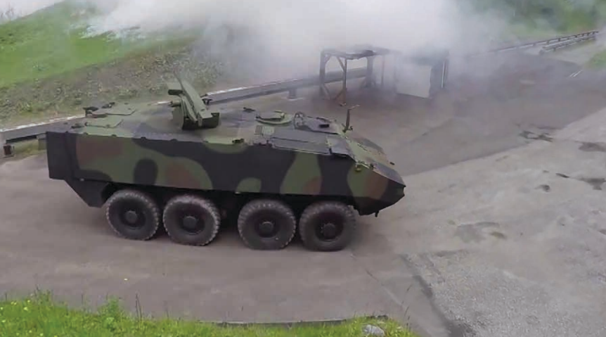
مركن السلاح المُشغّل عن بُعد Fieldranger 20، وهو نظام متوسط العيار مسلّح بمدفعٍ أوتوماتيكي عيار 20 ملم من نوع Rheinmetall Oerlikon-KAE. الصورة: Rheinmetall
