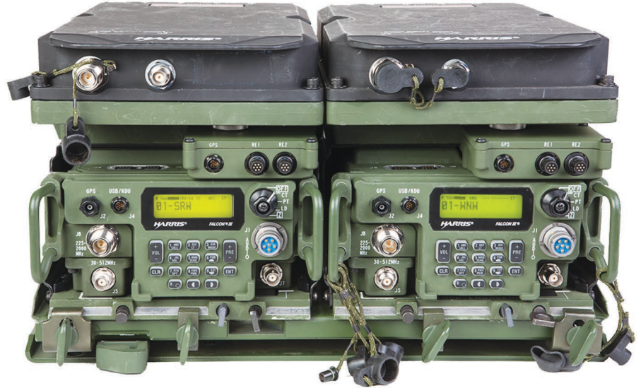
يستخدم راديو الجندي SRW على غرار AN/VRC-188(v) صنع L3Harris الترددات فوق العالية SRW UHF والحيز L-band، وهو الأمثل للاتصالات المتبادلة بين الوحدات على الأرض
