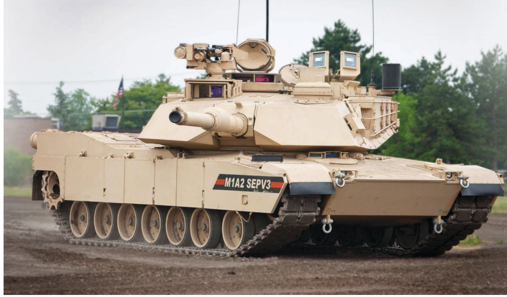
تعتبر دبابة M1A2 ABRAMS SEP V3 (توليفة النظام المحسن الطراز الثالث) الطراز الأحدث المطور من M1A2 SEP V2. وأصبح هذا الطراز قيد الخدمة في العام 2017، وبدأت ميدنته في العام 2020. الصورة: GDLS
