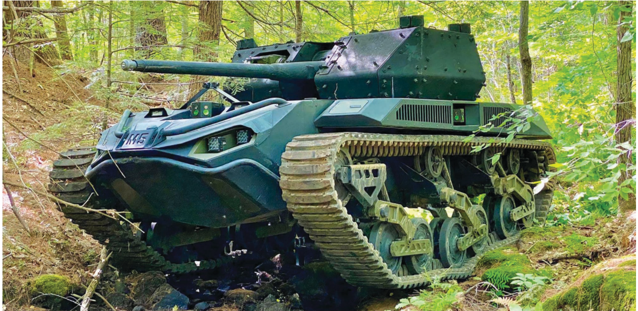
اختبر الجيش الأميركي الدبابة التكتيكية غير الأهلة Ripsaw M5 التي باستطاعتها حمل مجموعة متنوعة من أنظمة الأسلحة المشغلة عن بعد. الصورة: Textron Systems
