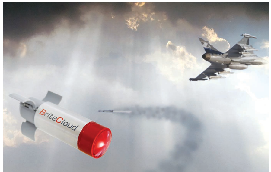
طوّرت Leonardo نظام الأشراك الخداعية المُستهلكة BriteCloud، المتوافر في اشتراقين: BriteCloud-55 الذي يُجهز الطائرة المقاتلة بناثرات إجراءات مضادة عيار 55 ملم؛ وBriteCloud-218 الذي يُغطي أنظمة عيار 218 ملم.
