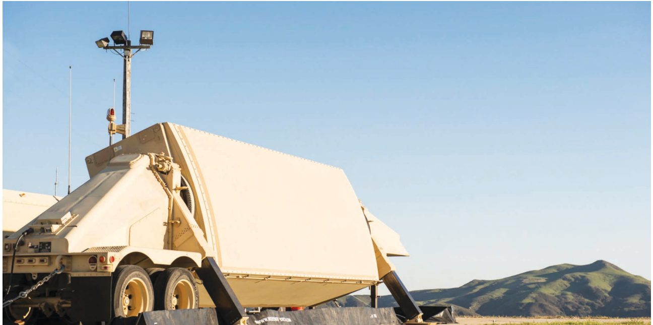
نظام المراقبة والسيطرة الرادارية النقال لقوات الجيش والبحرية AN/TPY-2. الصورة: Raytheon Missiles & Defense
