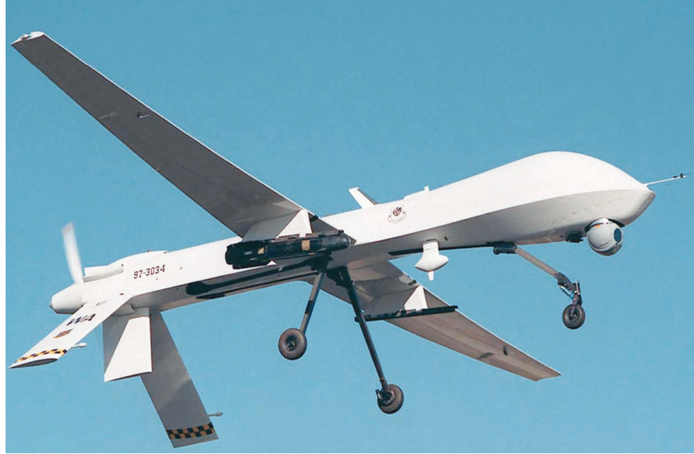
طورت GA-ASI عربة RQ-1 Predator إلى طراز هجومي تحت مسمى MQ-1 Predator الذي تم تسليحه بشكل أساسي بصاروخ AGM-114 Hellfire صنع Lockheed Martin
