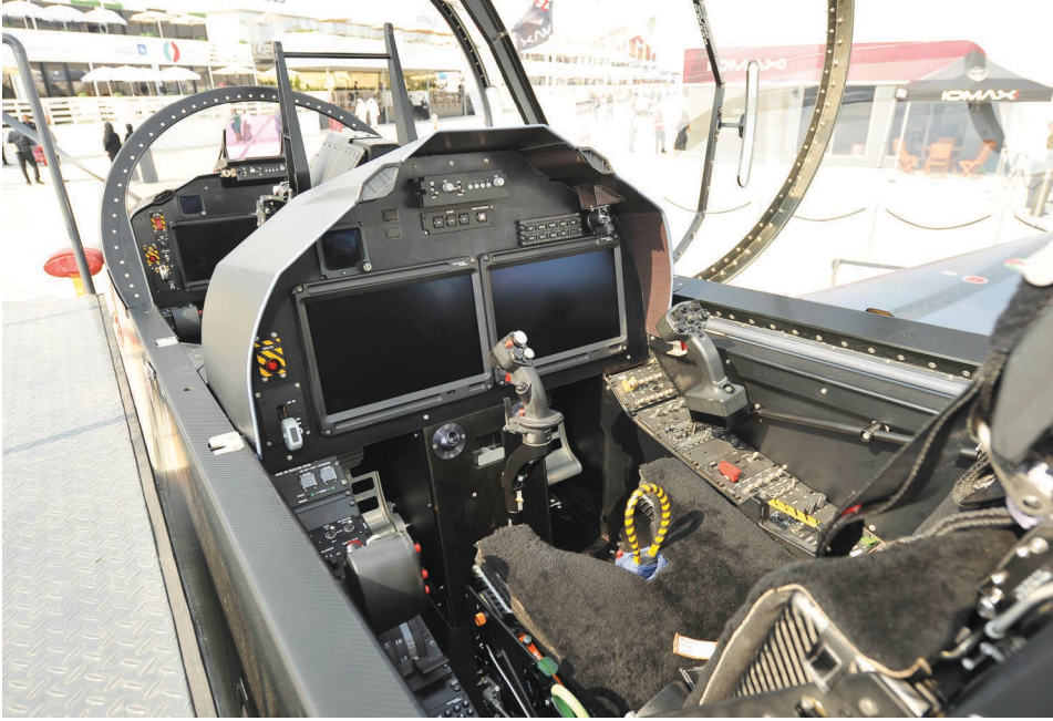
لدى طائرة B-250 نظام إلكترونيات طيران مدني Collins Aerospace Proline Fusion
