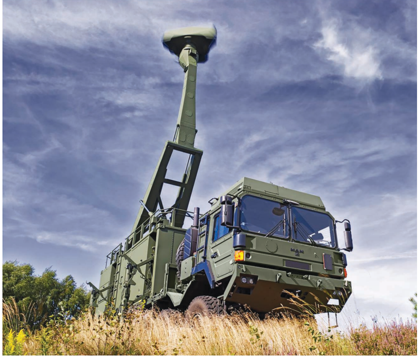
تم دمج رادار Giraffe AMB في نظام الدفاع الجوي المرتكز أرضاً الجديد الخاص بالجيش البريطاني والمعروف تحت مسمى Sky Sabre. الصورة: Saab
