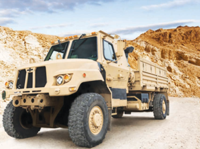
بالنسبة للجيش الأميركي، يتم تحقيق معظم قدرات النقل المتوسطة بواسطة «عائلة العربات التكتيكية المتوسطة» FMTV. الصورة: Oshkosh
