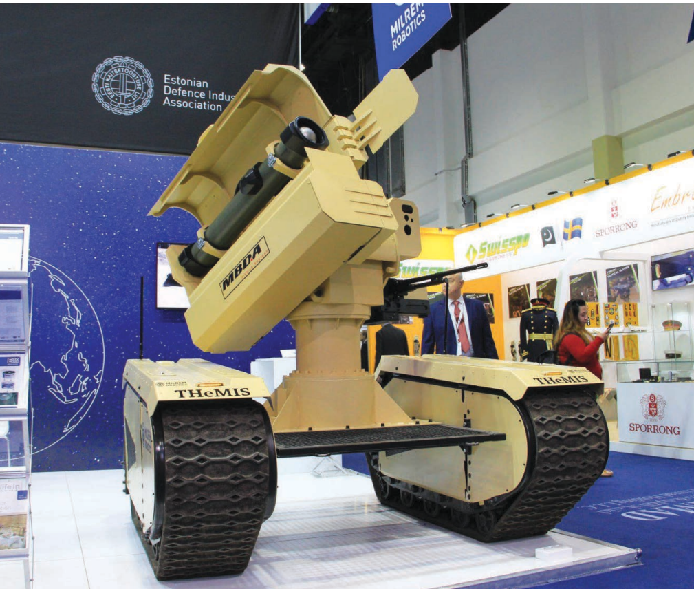
عرضت شركة Milrem Robotics العربة البرية غير الأهلة THeMIS مع نظام MBDA IMPACT في برج القتال (Integrated MMP Precision Attack Combatant) مجهزة بنظام الصاروخ المدمج MMP في برج القتال الهجومي الدقيق
