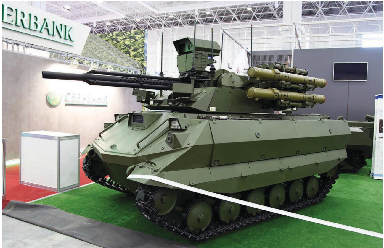
النظام الروسي الروبوتي القتالي المتعدد الأغراض URAN 9 الذي يتضمن نظام الصاروخ الموجه للدبابات ATAKA الصورة: Rosoboronexport
