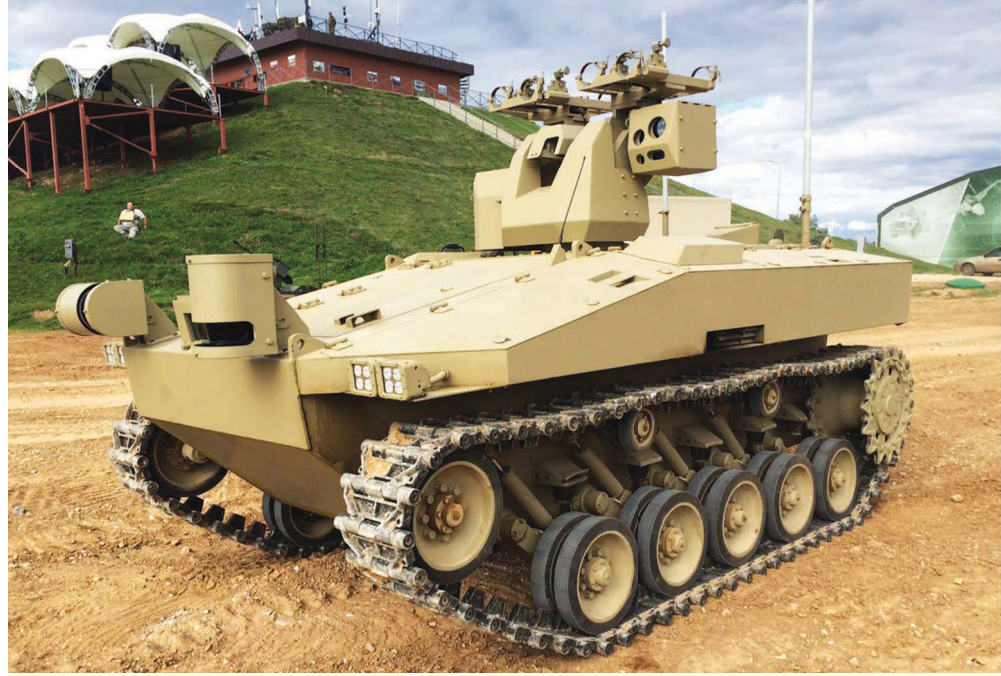
طورت Kalashnikov نظام BAS-01G Soratnik UGV حيث يمكن تسليح مركز أسلحته برشاش ثقيل عيار 12.7 ورشاش متوسط عيار 7.62 ملم وقاذف رمانات أوتوماتيكي AG-17A عيار 30 ملم، وقاذف صواريخ أوتوماتيكي جديد عيار 40 ملم
