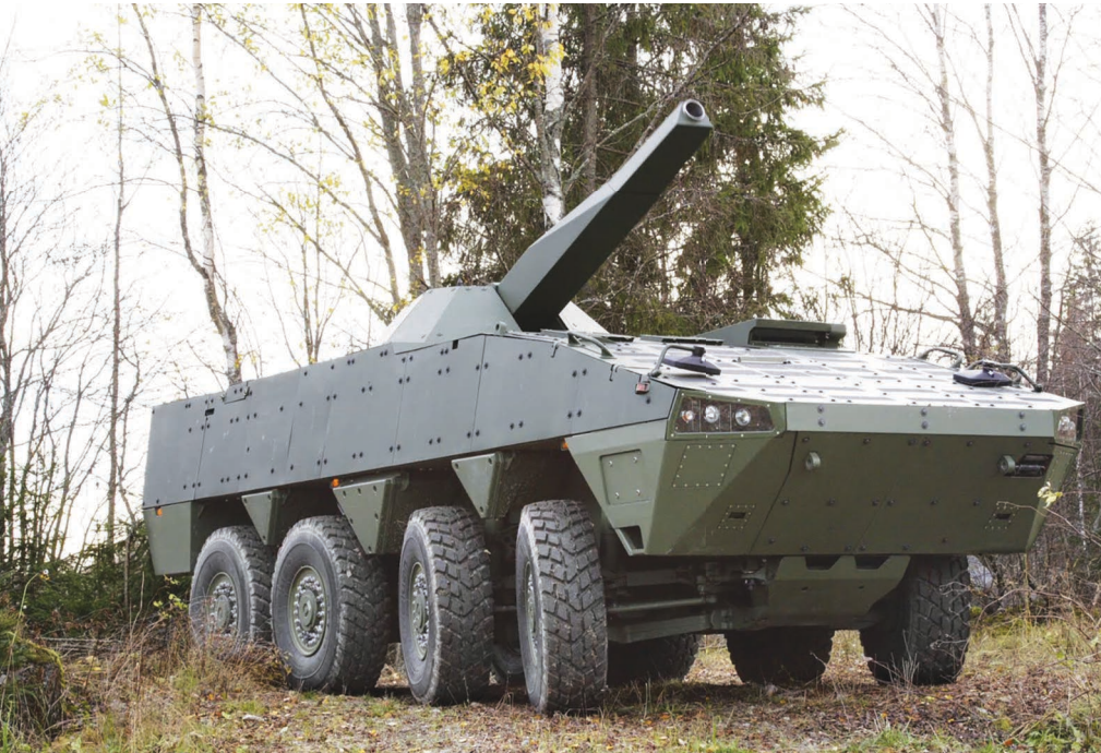
طورت Patria نظام الهاون الأحادي السبطانة ذات الجوف الأملس NEMO (New Mortar) لتوفير بديل أقل كلفة من AMOS
