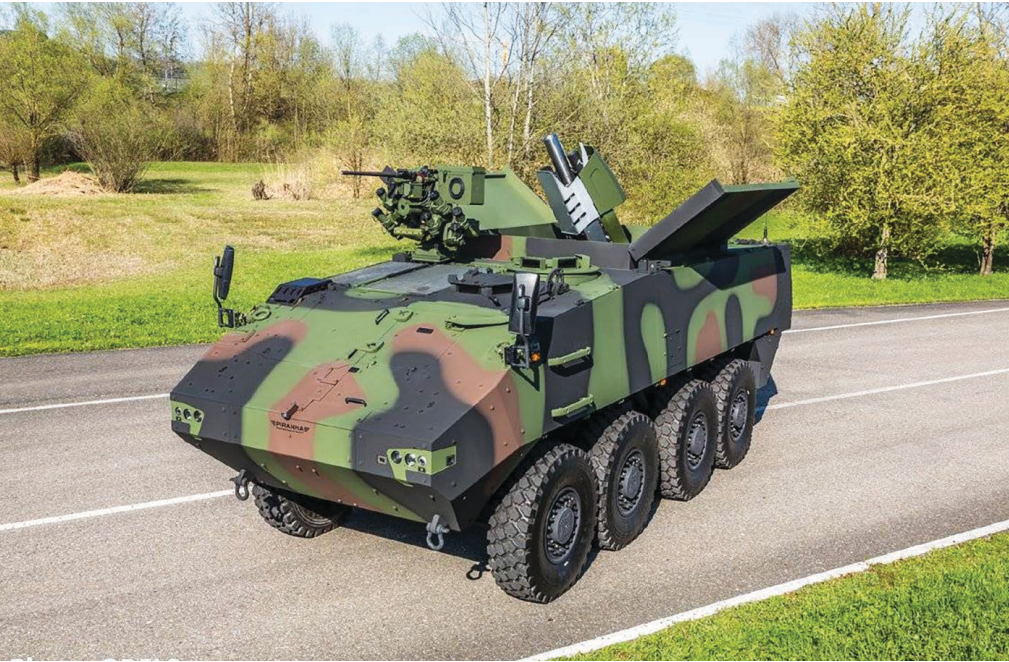
مدفع الهاون Cobra عيار 120 ملم ذو الجوف الأملس صنع RUAG Defence مركباً على عربة +3 Piranha صنع GDELS
