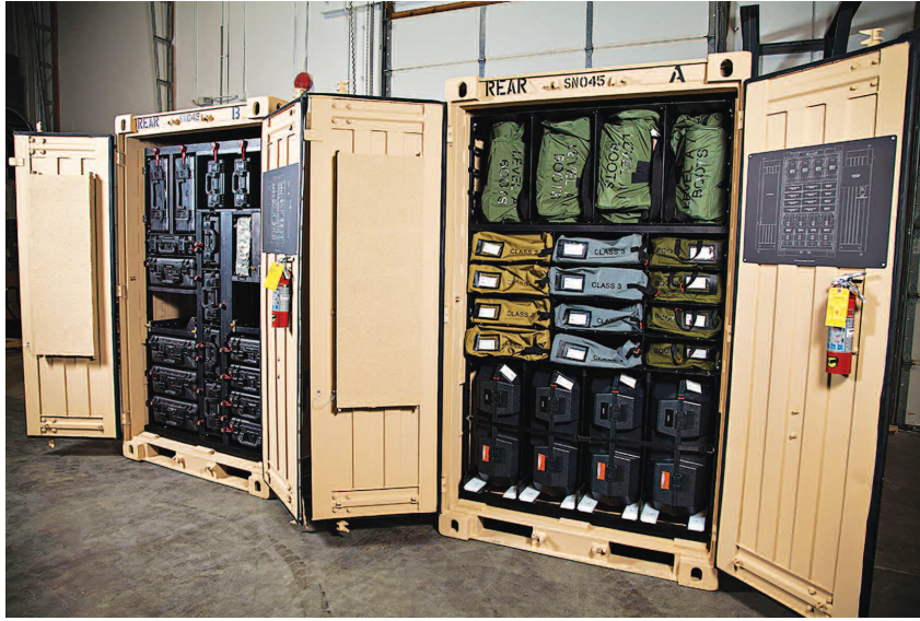
يوفر نظام FLIR DR SKO مجموعة مدمجة من أطقم رصد وتعريف واختبار وأخذ عينات لعوامل CBRNE وغيرها ذات الصلة بالسلامة الشخصية التي تتيح للجنود إجراء مهام تقييم وإدارة التداعيات في الموقع. الصورة: FLIR Systems
