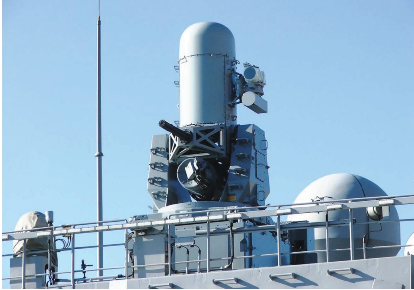
نظام السلاح عن قُرب CIWS للدفاع ضدّ الصواريخ المضادة للسفن Block 1B Phalanx عيار 20 ملم صنع Raytheon
