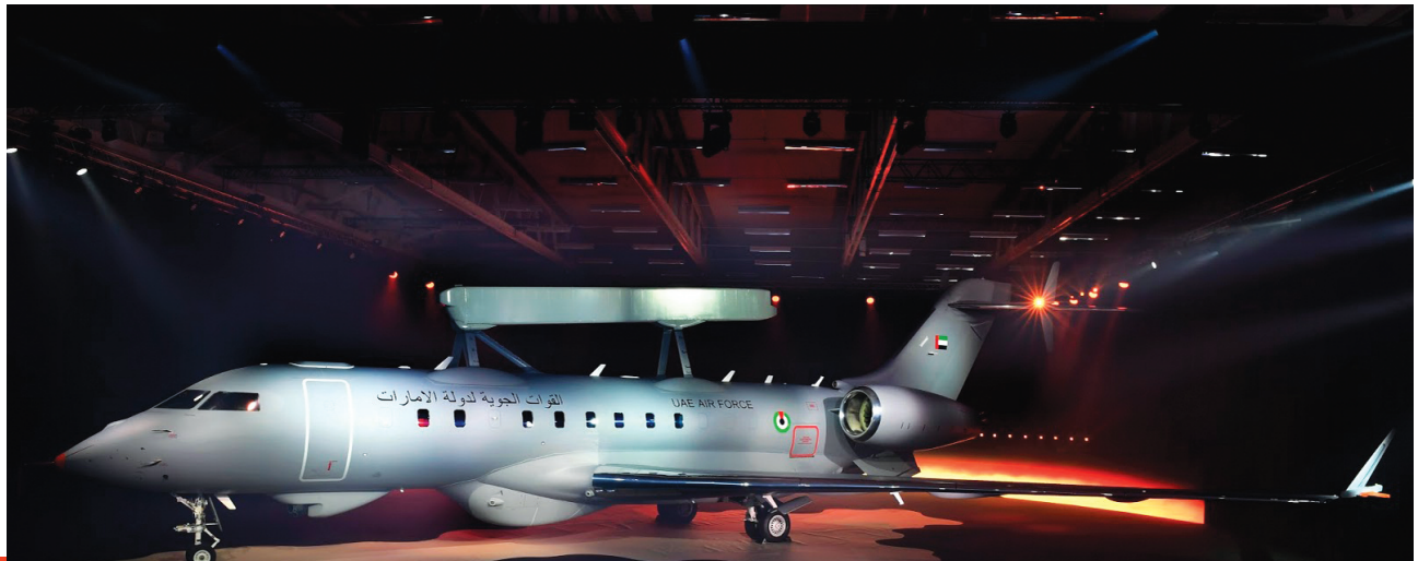
تم إدماج «رادار صفييف المسح الإلكتروني النشط» Seaspray صنع Leonardo في طائرة الإنذار المبكر Saab-GlobalEye
