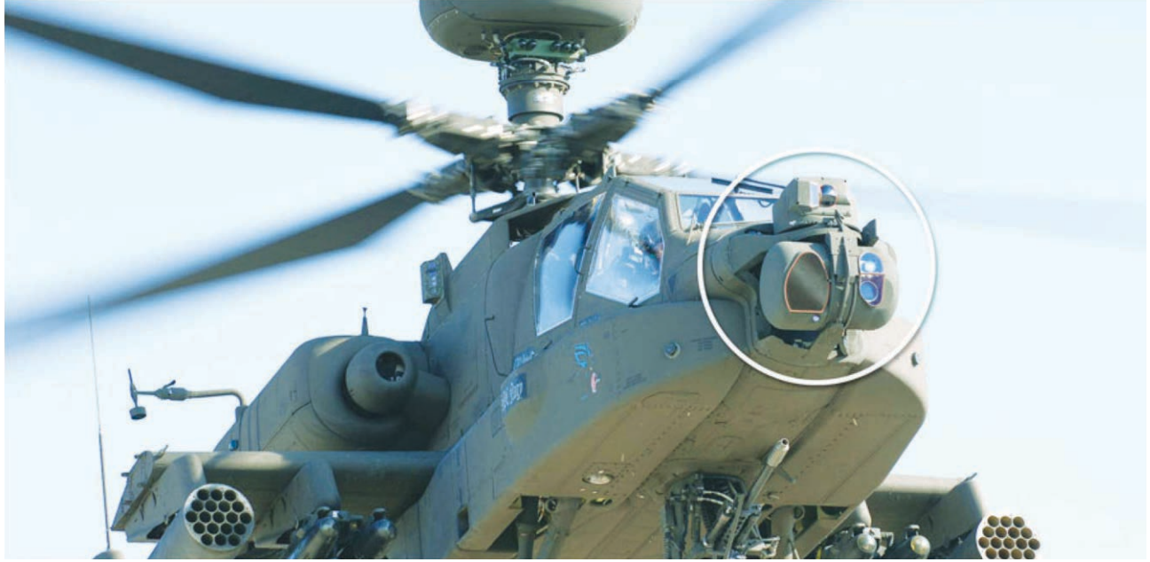
توفّر شركة Lockheed Martin أيضاً تهديفاً أفضل في ضوء النهار وفي الضوء الخافت للطوّافة الهجومية «آباتشي» Apache بفضل «مجمّع المستشعر النهاري M-DSA» النحّث
