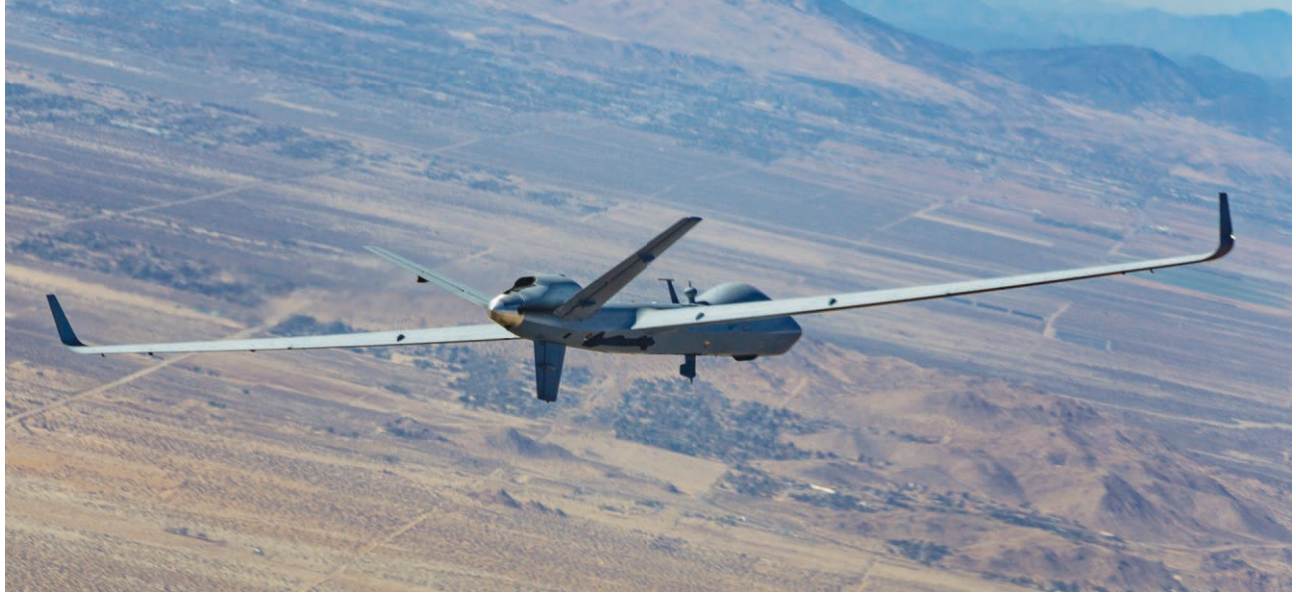
صمم طراز SkyGuardian من Predator B للعمل تحت الشروط الصارمة للصلاحيات الجوية في المجال الجوي غير العسكري. الصورة: GA-ASI
