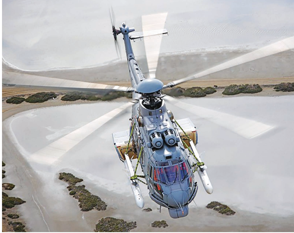
تُرَكِّز طوافة H225M من Airbus Helicopters، على المراقبة البحرية و«الحرب المضادة لسفن السطح» ASuW، حيث يُستخدم في المهمة الأخيرة زوج من صواريخ MBDA AM39 Exocet
