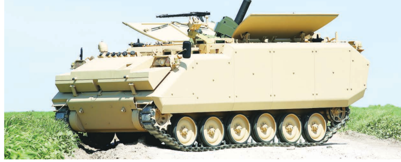
نظام الهاون الذاتي الدفع عيار 120 ملم مركباً على عربة القتال المدرعة FNSS. الصورة: ACV-19 SPM
