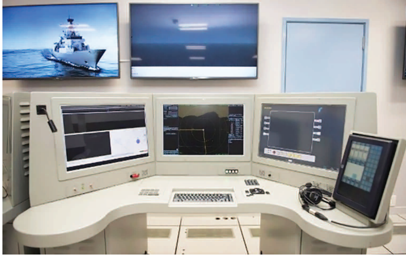
CMS 330 الحديث من شركة Lockheed Martin Canada هو نظام إدارة القيادة لفئة الحماية المستقبلية
