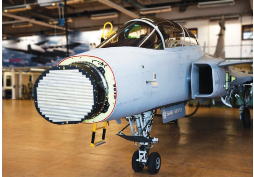
يتميز رادار ES-05 Raven المخصص لمقاتلات Saab Gripen E/F بهوائي AESA يشمل على «آلية إعادة تموضع الرادار الدوّارة» (roll-repositionable) مبتكرة
