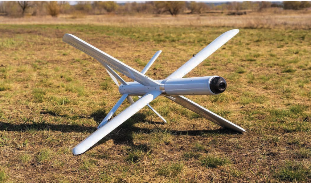
نظام الذخيرة الجوية غيرالأهلة «Silent Thunder» ST-35 هو نظام أسلحة تحوم فيه الذخيرة حول منطقة الهدف لبعض الوقت ، وتبحث عن أهداف أو تستخدم بيانات استطلاع من مصادر أخرى ، وتهاجم بمجرد تحديد الهدف. الصورة: Athlon Avia الأوكرانية
