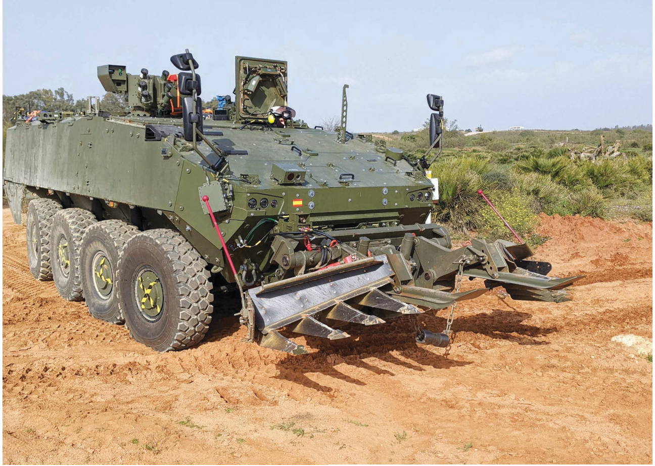
الألغام. الصورة: Pearson Engineering. عبارة Vector عبارة عن محراث الغام ذاتي الحماية مصمم لتزويد العربات القتالية المدولية وغيرها من العربات الخفيفة الوزن، بالقدرة على التحرك عبر حقول
