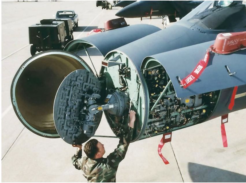
يعتبر رادار Raytheon AN/APG-63(V)2 الرادار الأمريكي الأول من عائلة AESA، وهو يشكل تحديثاً رئيسياً لـ 18 مقاتلة من طراز Boeing F-15C
