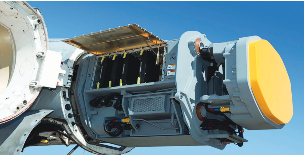
كانت شركة Raytheon السباقة في إنتاج الرادار AN/APG-79، وهو طراز محدث من رادار المسح الميكانيكي APG-65 وعائلة APG-73 الجديدة، واضطلعت شركة Northrop Grumman بمسؤولية تصميم وتوريد هوائي الصيف الممرح الذي يعمل بالحيز X. وتم تصميمه لتجهيز مقاتلات F/A-18E/F Super Hornet برادار AESA
