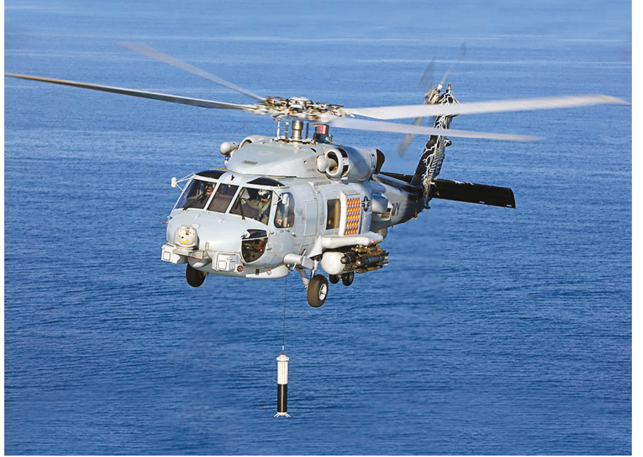
طوافة MH-60R تستخدم السونار المحمول جواً ذا الترددات المنخفضة ALFS. الصورة: Raytheon
