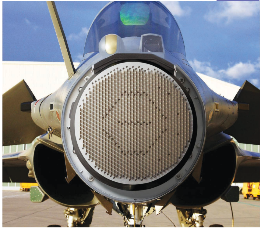
لا تزال فرنسا على طريق تسلم رادار AESA RBE2-AA لمقاتلاتها من طراز Dassault Rafale
