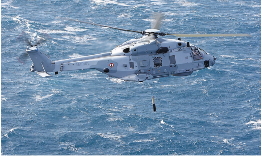
طوافة NH-90 تستخدم السونار الغاطس FLASH الذي يعتبر المرجع العالمي في مجال السونارات الغاطسة وهو يستخدم في القوات البحرية الأميركية، والبريطانية، والأسترالية والفرنسية وغيرها. الصورة: Thales
