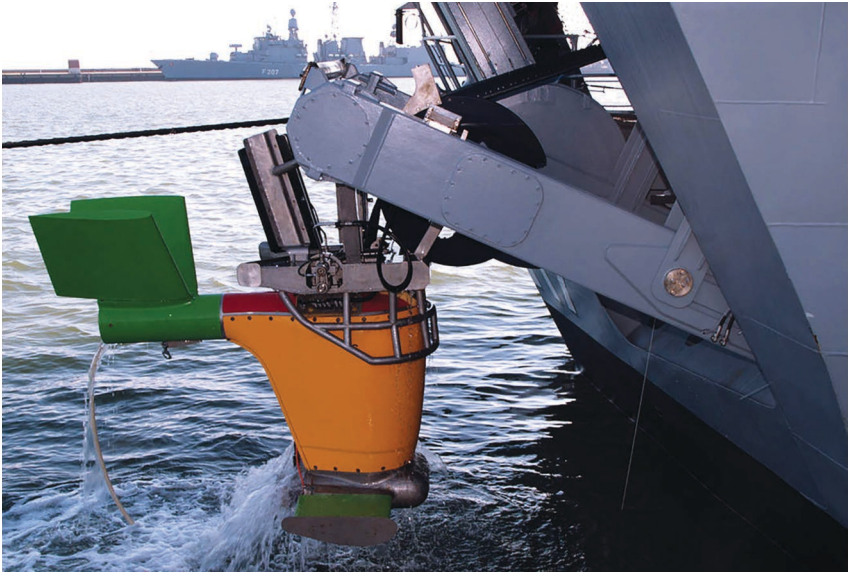
سونار الصفيق المقطور النشط ACTAS ذو الترددات المنخفضة. الصورة: ATLAS Elektronik
