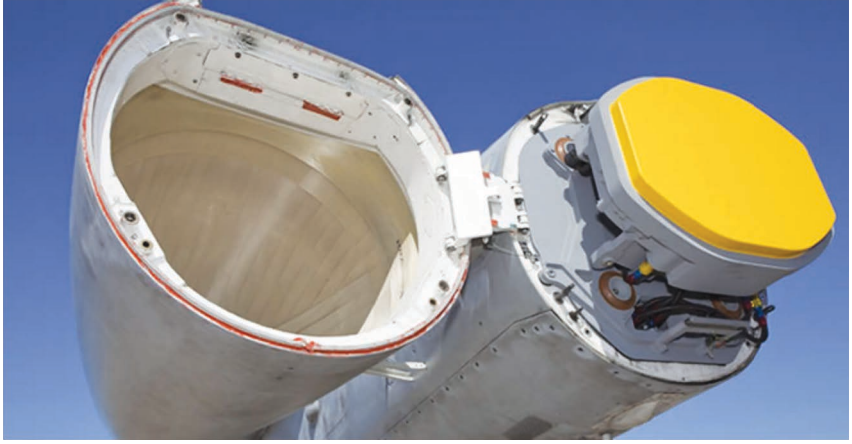
تنتج Raytheon رادار APG-79 لطائرة Boeing F/A - 18 E/F Super Hornet وطائرة EA-18G Growler
