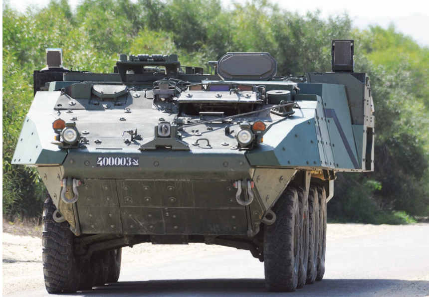
نظام الحماية النشط « AWISS APS مركباً على ظهر عربة قتال مدرّعة. الصورة: DIEHL BGT Defence
