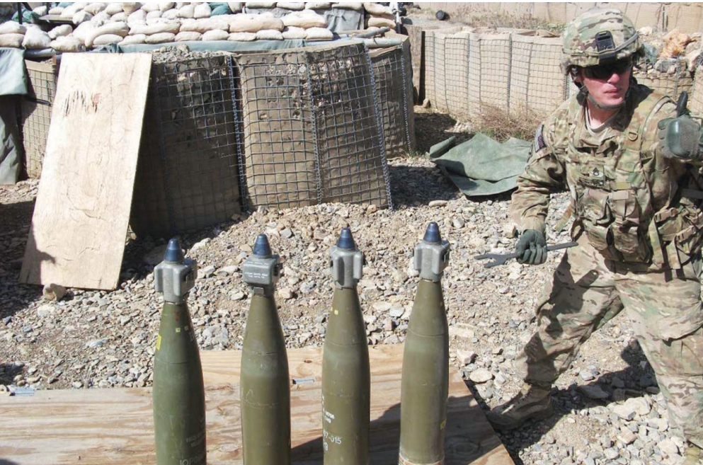
تطور Northrop Grumman «وحدة توجيه دقيق» PGK، وهي تستخدم لتحويل قذيفتي المدفعية عيار 155 ملم M795 و MS49A1 إلى أسلحة ذكية
