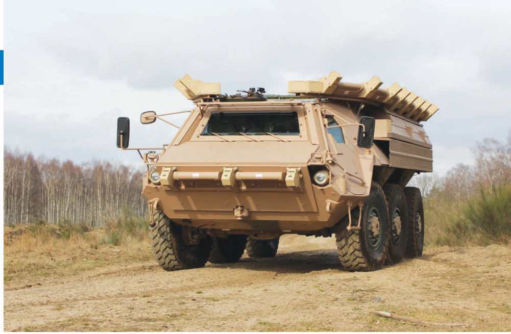
«أنظمة الحماية النشطة» APS ، التي يمكنها أن تعترض المقذوفات الداهمة وتدمرها قبل اصطدامها بالعربة، مركبة على ناقلة الجند المدرعة Fuchs. الصورة: Rheinmetall.
