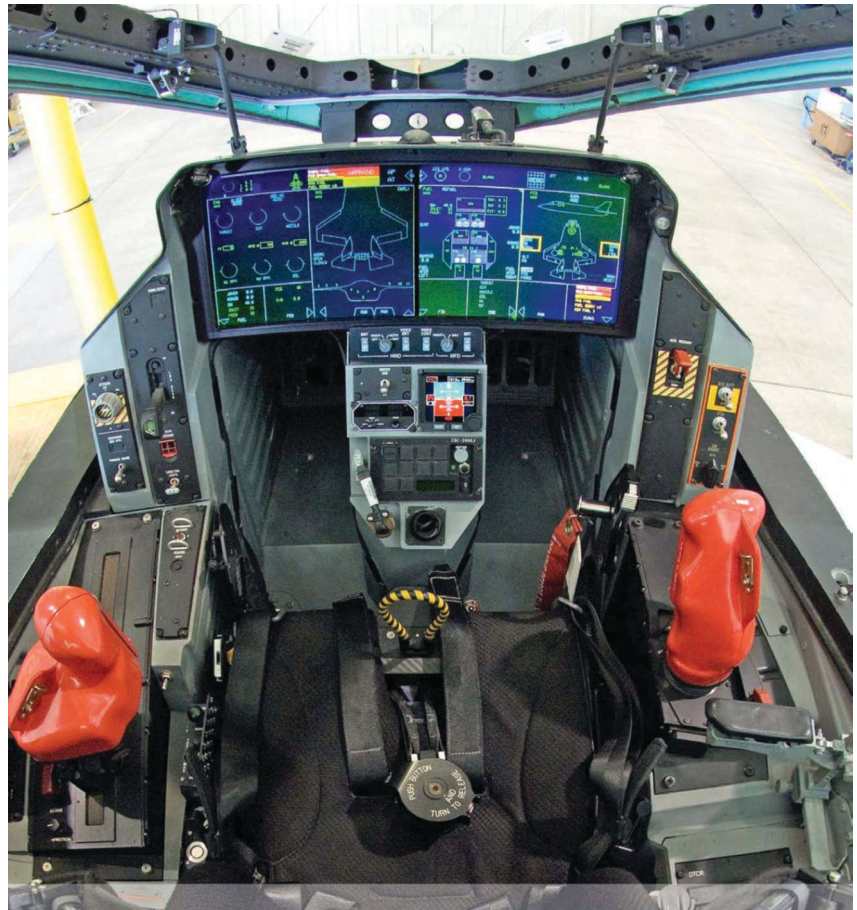
شاشة العرض للمسيرة، التي هي حدّها ذاتها جديدة بالكامل وفريدة في قمرة قيادة مقاتلة Lightning، تعرض فوراً مجموعة من المعلومات التي جُمِعت معاً على نحو أمثل
