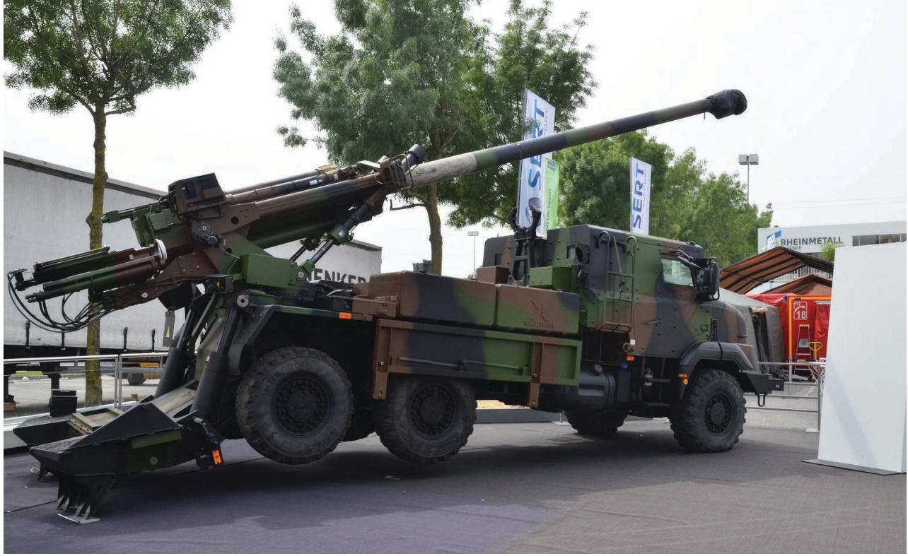
مدفع Caesar عيار 155 ملم مركباً على شاحنة سداسية الدفع. الصورة: Nexter
