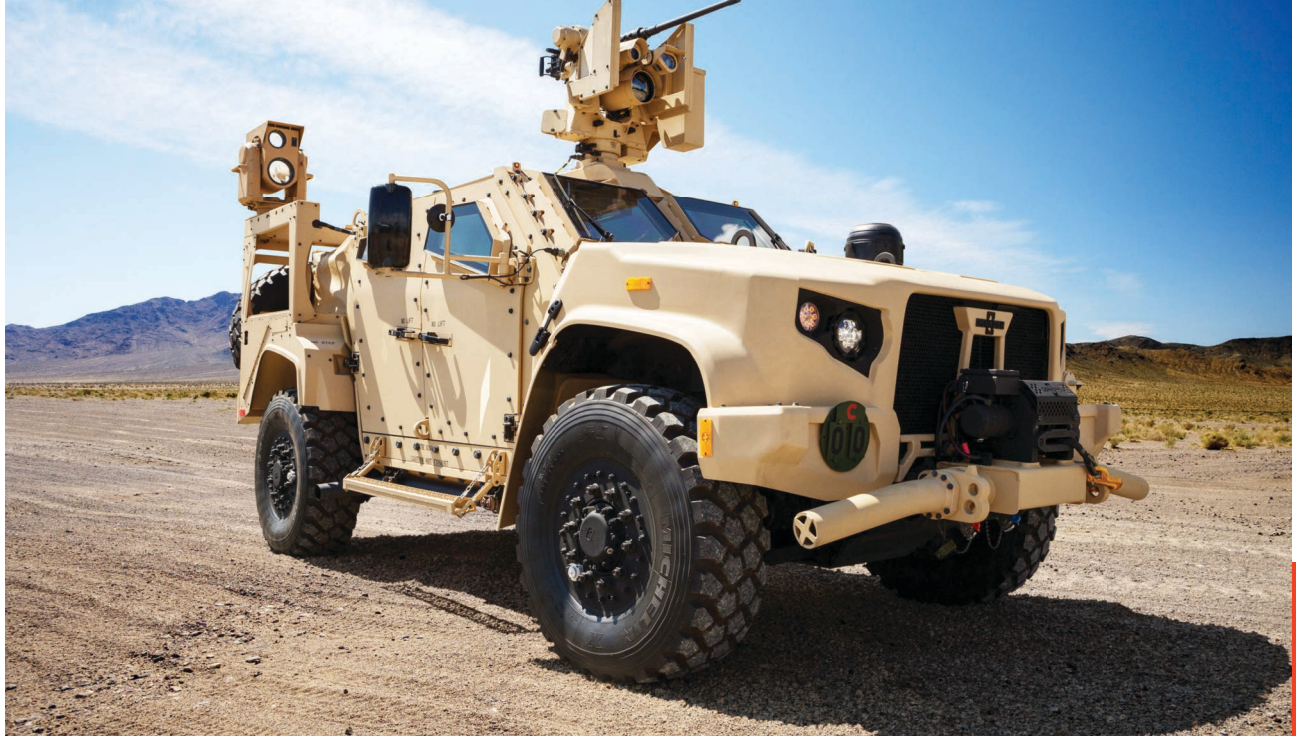
العربة التكتيكية الخفيفة المشتركة JLTV مجهزة بمركز السلاح المشغل عن بعد Protector LW 30 صنع Kongsberg. الصورة: Oshkosh Defense
