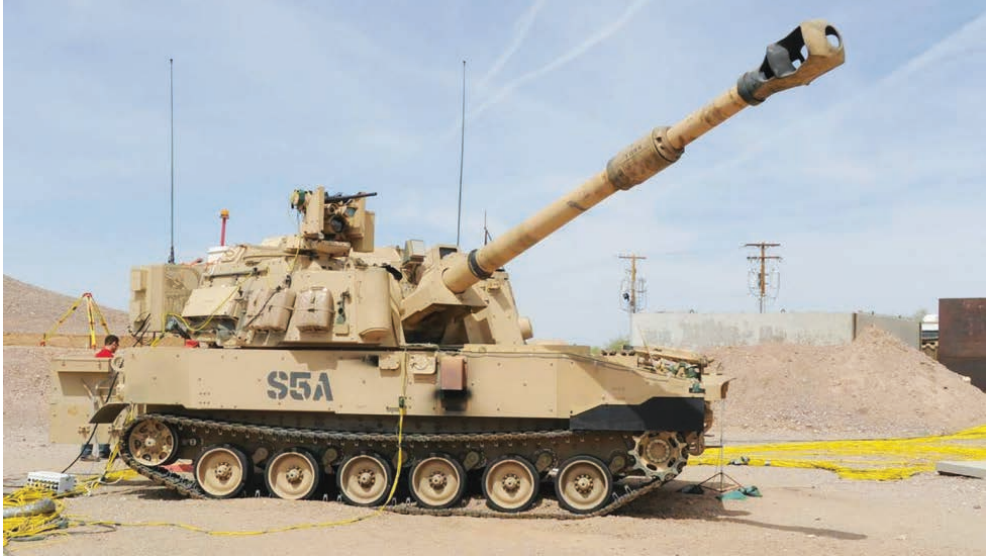
لا يزال الجيش الأميركي يستخدم الكالبر 39 في المدفع ذاتي الحركة M109 حتى في طرازه الأحدث M109A7. الصورة: BAE Systems
