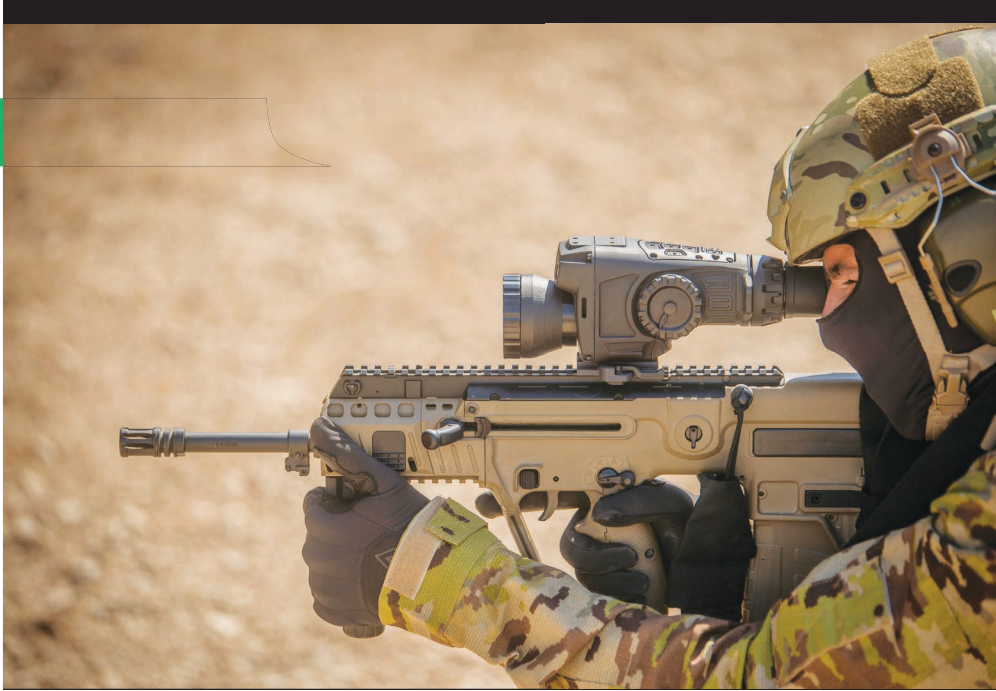
نظام NYX-200، وهو منظار سلاح متعدّد الطيف يجمع معاً كاميرا حرارية غير مبرّدة وكاميرا نهاريّة/ليليلة رقمية لتحسين إدراك الوضع المحيط وذلك بإتاحة «حيازة سريعة للهدف» RTA في أية ظروف أو بيئات ضوئية. الصورة: Meproflight
