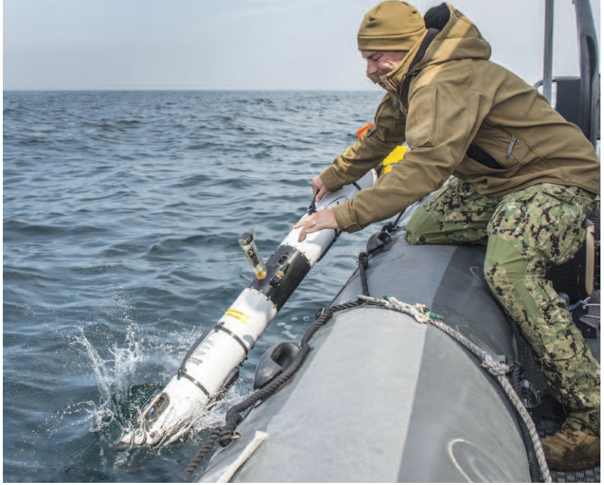
قامت «عربة تحتماثية من نوع OceanServer IVER-3 بجمع بيانات دراسة أعماق البحار والطوبوغرافيا. الصورة: L-3
